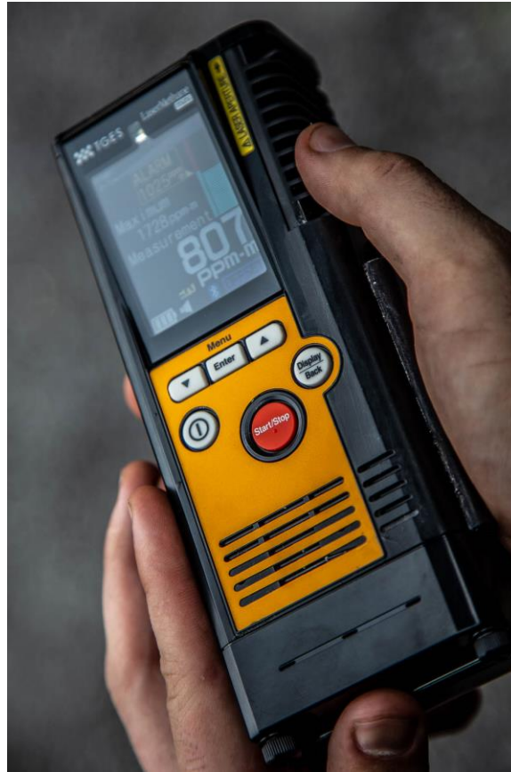
Figure 2:4 Openpath Handheld Laser Methane Mini
